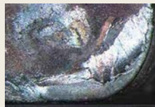
Usura di craterizzazione elevata
